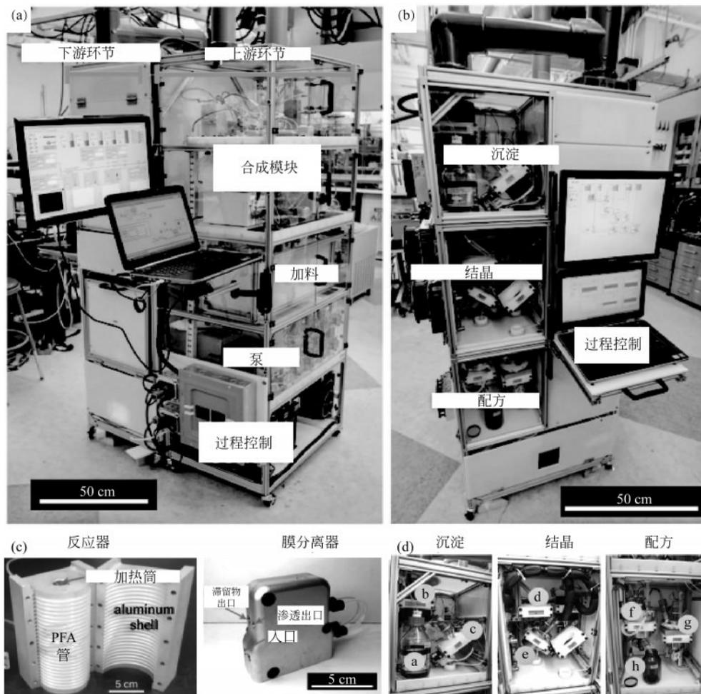
图 32 麻省理工学院“冰箱式”迷你制药工厂<sup>[45]</sup>
