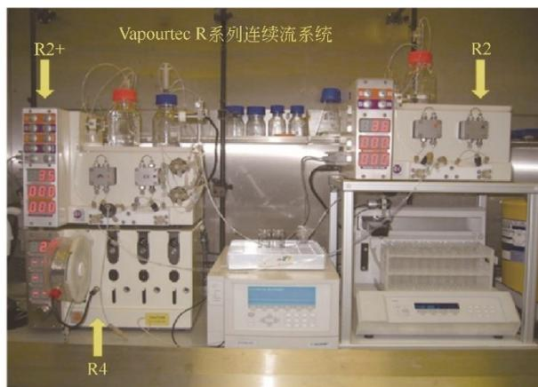
图10 Vapourtec R系列流动反应器<sup>[64]</sup>
