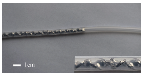
图2 内置SK型静态混合元件反应管道
